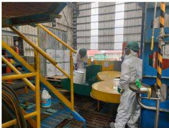
Figura N° 5: Personal realizando la apertura de cilindros.
